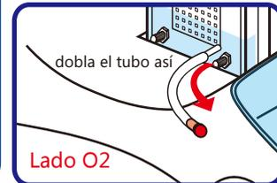
Procedimiento para repetir la producción de gas: Desconectar los pequeños tapones de los tubos enchufados a las boquillas de la célula reversible de combustible. Esto permitirá que el agua entre al interior de los cilindros para sustituir a los gases y se restablezca el nivel de agua en la marca "0". Insertar de nuevo los tapones en los tubos y repetir la electrólisis.
