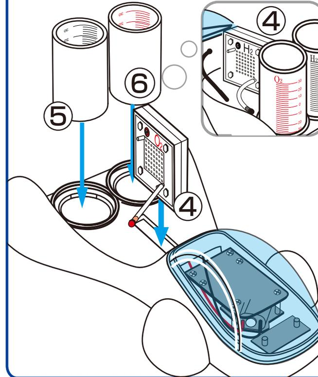
**8.** En primer lugar añade agua hasta la marca "0". Coloca los recipientes de gas en el interior de los depósitos externos. Las ranuras no han quedar bloqueadas por los bordes del plástico interior. A continuación, conecta el tubo al recipiente interior. Asegúrate de que no hay aire atrapado en el interior de los contenedores y que están llenos de agua hasta la marca "0".
