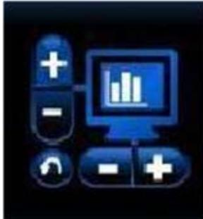
verticaux + et - contrôlent l'échelle verticale et les boutons horizontaux + et - contrôlent l'échelle du temps.
